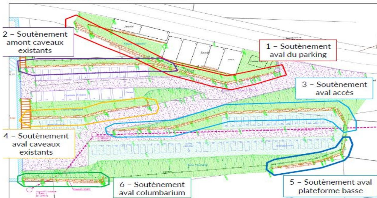
Chacun de ces murs présente d'importantes faiblesses, les murs 1 et 3 entraînant des effondrements des voies d'accès, et les escaliers figurant à gauche du plan de récolement sont eux aussi défectueux. Des travaux de maçonnerie sont également nécessaires sur les murs du plus grand des anciens cimetières (cimetière n°2, dit « cimetière des cyprès »).
